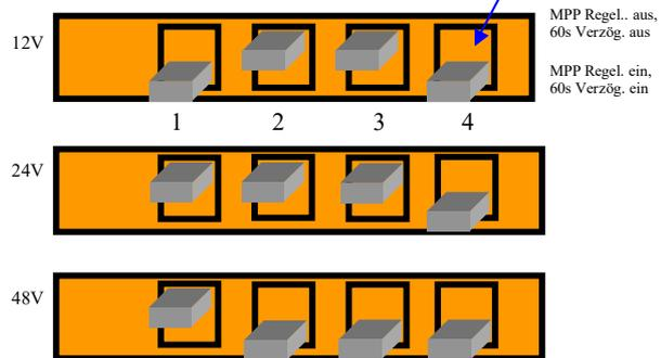
Durch Drücken der **Reset Taste**, während die **MPP Regelung ausgeschaltet** ist, kann man manuel den MPP des Windgenerators einstellen.
